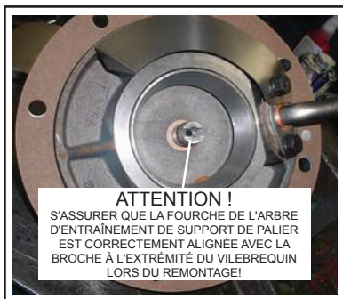
Fig. 5-5 Alignement de l'arbre d'entraînement
