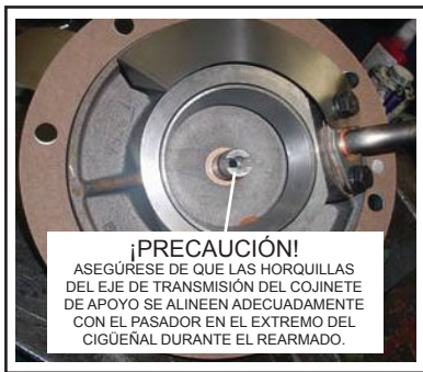
Fig. 5-5 Alineación del eje de transmisión
